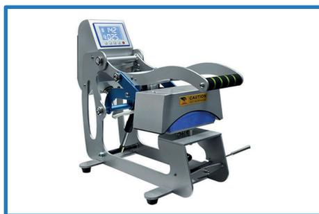
Ao descer efetuar a prensagem o eletroímã ligará e iniciará a contagem do tempo, assim que a contagem chegar a 5 segundos começará a emitir um sinal sonoro avisando que ao chegar em 0 a prensa abrirá automaticamente;
