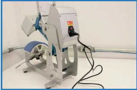
Colocar o cabo de força AC (corrente alternada) na prensa e liga-lo na TUE (tomada de uso específico) e identificar se a tensão da prensa e da tomada são as mesmas;
