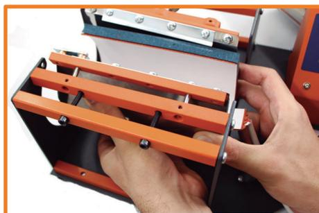
Insira a resistência a ser utilizada, prestando atenção ao encaixe dos parafusos;
