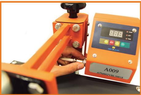
Remova o cabo da resistência da base plana;
