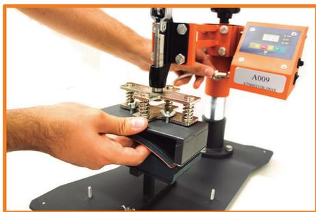
Insira a base superior da resistência de boné no suporte e rosqueie-as. Não se esqueça de inserir o cabo da resistência;
