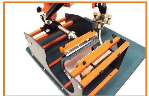
Pronto! Para utilizar outra resistência lembre-se de remover e inserir o novo cabo;
